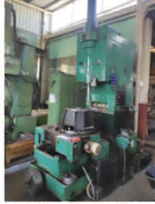
14 Modül Fellow Çap 1500mm Strok 250mm Tabla Kesici Arası 900mm
