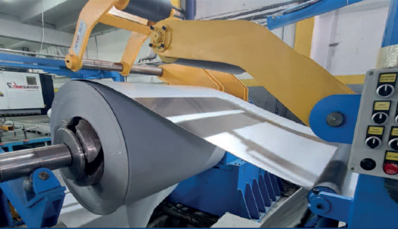
Boy Kesme Hattı / Cut To Length Line: Kalınlık / Thickness: 0,3mm - 3mm Genişlik / Width: 100mm-1550mm
