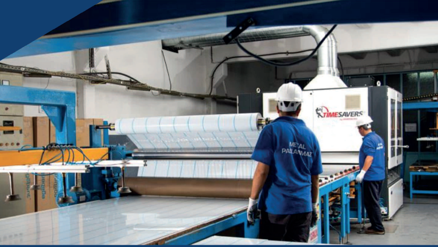
Taşlama Hattı/ Grinding Line: Kalınlık / Thickness: 0,5mm - 5mm Genişlik / Width: 700mm - 1550mm
