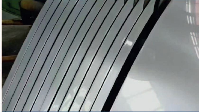
Dilme Hattı / Slitting Line: Kalınlık / Thickness: 0,3mm - 3mm Genişlik / Width: 10mm - 1550mm
